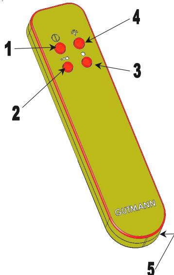
**Bouton 3:** Allure intensive (le moteur revient automatiquement sur l'allure 3 au bout de 3 mn)
