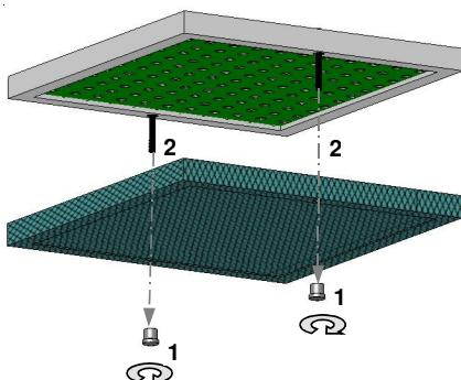
Prima della pulizia, scomporre il filtro metallico, smontando i manici. Ora il filtro metallico può essere scomposto in singole lastre di filtraggio. Eseguire la pulizia preferibilmente nella lavastoviglie usando un detersivo delicato.
