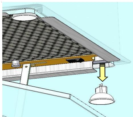
Nach dem Abkühlen muss das Leuchtmittel mit beiden Fingern am Rand gehalten werden, dann das Leuchtmittel gefühlvoll nach unten ziehen (Steckfassung) bis sich das Leuchtmittel aus der Fassung löst. Beim Einsetzen des neuen Leuchtmittels unbedingt den Kontakt mit der Haut vermeiden, hierzu ein saubereres Tuch verwenden.
