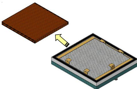
El filtro de carbón activo está montado con un marco en el filtro de metal. Deberá desmontarse el filtro de metal para cambiar el filtro de carbón activo. Ahora se puede desplazar lateralmente del marco el filtro de carbón activo (desplazar en la dirección en la que no se encuentre ningún cubrejuntas-guía). Reemplazar el filtro después de haber quitado el filtro de carbón activo. El montaje se realiza en orden inverso. Importante: El filtro de carbón activo no puede ser limpiado mojándolo.
