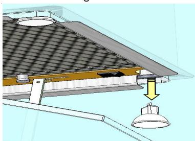
vastgehouden worden. Vervolgens het verlichtingsmiddel fijngevoelig omlaag trekken (plugfitting) totdat het verlichtingsmiddel uit de fitting loskomt). Bij het aanbrengen van het nieuwe verlichtingsmiddel beslist het contact met de huid vermijden. Hiervoor gebruik maken van een schoon doekje.
