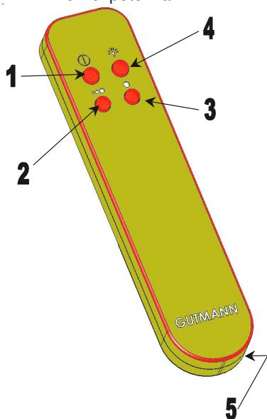
Pulsante 3: livello intenso (il motore torna automaticamente al livello 3 dopo 3 minuti)
