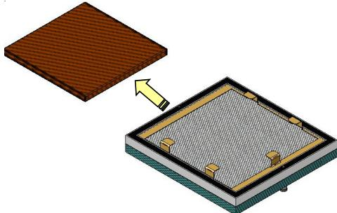
Il filtro a carbone attivo è montato sul filtro metallico con un telaio. Per la sostituzione del filtro a carbone attivo, smontare il filtro metallico. Ora estrarre il filtro a carbone attivo lateralmente dal telaio (spingere nella direzione priva di linguetta di guida). Dopo la rimozione del filtro a carbone attivo, sostituirlo con un filtro nuovo. Il montaggio avviene nella sequenza invertita. Importante: il filtro a carbone attivo non deve essere pulito ad umido.
