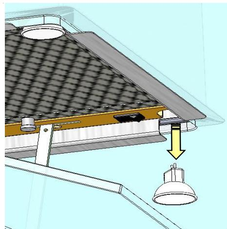
Después de enfriada, la luminaria debe sostenerse con dos dedos por el borde, luego tirar hacia abajo cuidadosamente (portalámpara de enchufe) la luminaria hasta que ésta se suelte del portalámparas. Evitar sin falta el contacto de la piel al colocar la luminaria nueva, utilizar para esto un paño limpio.
