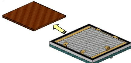
bevinden, schuiven). Nadat de actieve koolfilter verwijderd werd, deze door een nieuwe filter vervangen. De montage gebeurt in omgekeerde volgorde. Belangrijk: de actieve koolfilter mag niet nat gereinigd worden.
