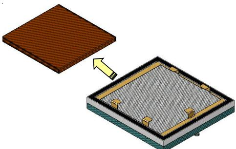
bauen. Nun den Aktivkohlefilter seitlich aus dem Rahmen schieben (in die Richtung schieben an der sich keine Führungslaschen befinden). Nach dem Abnehmen des Aktivkohlefilters diesen durch einen neuen Filter ersetzen. Der Einbau erfolgt in umgekehrter Reihenfolge. Wichtig: Der Aktivkohlefilter darf nicht nass gereinigt werden.
