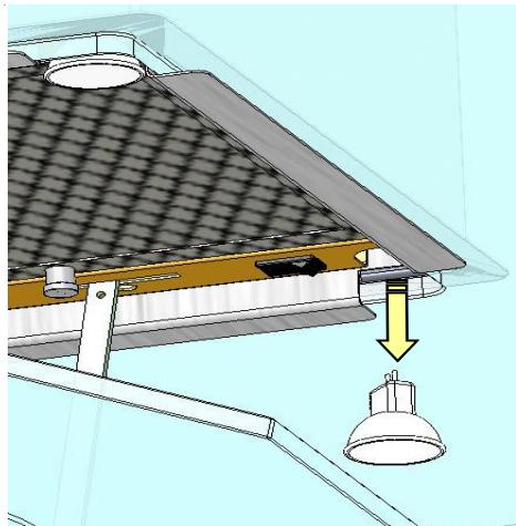
Lors de la mise en place de la nouvelle lampe, éviter absolument le contact avec la peau, se servir d'un chiffon propre.
