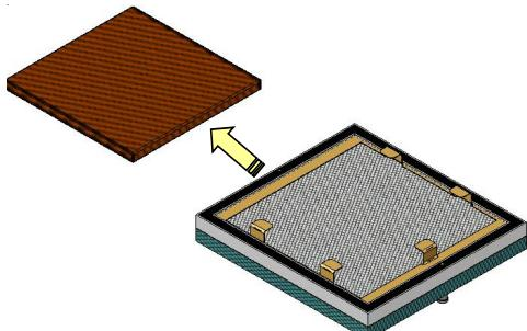
Le filtre à charbon actif est monté avec un cadre sur le filtre métallique. Pour remplacer le filtre à charbon actif, démonter le filtre métallique. Pousser maintenant le filtre à charbon actif sur le côté hors du cadre (pousser dans le sens où se trouvent les languettes de guidage). Après avoir retiré le filtre à charbon actif, le remplacer par un nouveau. Le remontage s'effectue dans l'ordre inverse. Important : Le filtre à charbon actif ne doit pas être mouillé.
