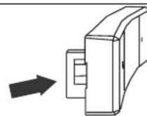
Los interruptores basculantes cuentan con una protección antigiro (puente inferior, más ancho) para que los interruptores se puedan introducir correctamente.
