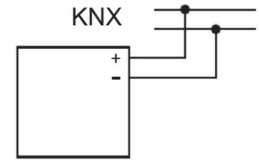
Anschluss des (separaten) Bus- /Netzankopplers
