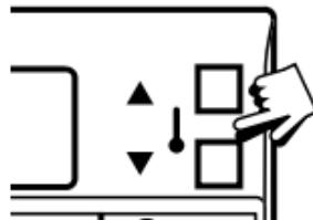
*El TP5 se mantendrá a esta mayor temperatura hasta el próximo cambio de temperatura preprogramado.*
