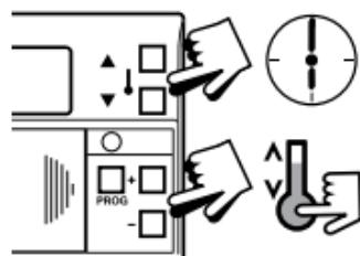
Naciskaj pržycisk **PROG** do momentu, gdý na x ýsx iešlaczú cieklokryštaliczným (LCD) žacźnie migać žnak dx úkropka.
