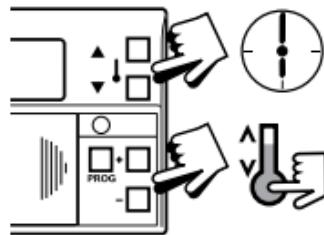
Pulse PROG hasta que los dos puntos de la pantalla LCD comiencen a parpadear.
